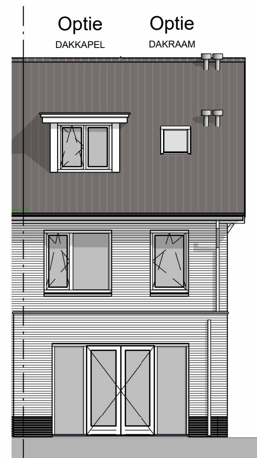
Optie DAKKAPEL Optie DAKRAAM Optie SAMENGESTELDE PUI MET DUBBELE TUINDEUREN Optie UITBOUW 2.4 m.
