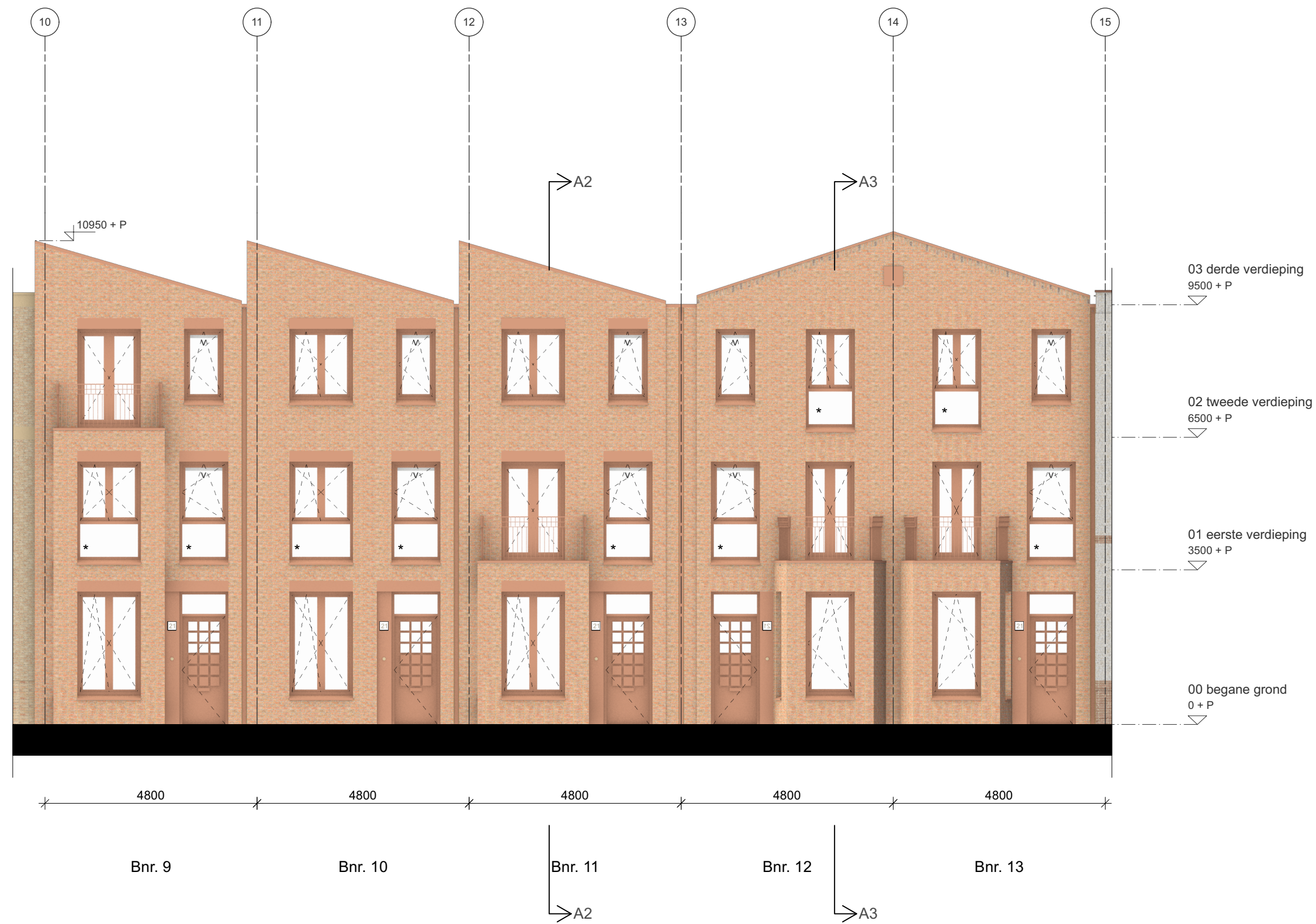
Voorgevel Bnr. 9 t/m 13
