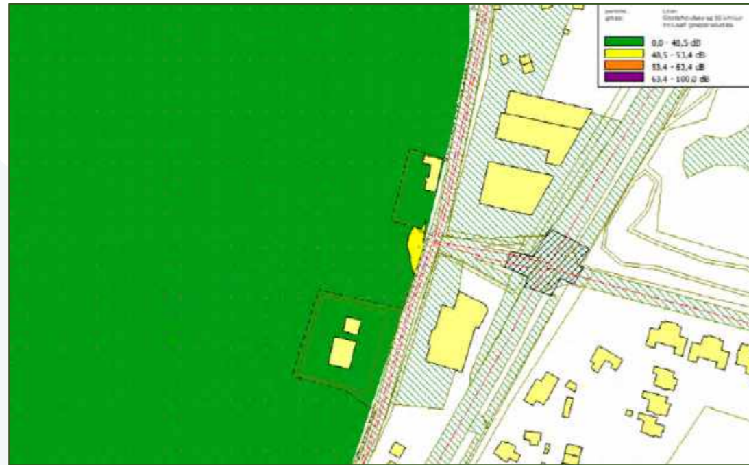
Figuur 4.12: geluidbelasting t.g.v. wegverkeer op de Oosterhoutseweg (30 km/uur) incl. aftrek artikel 110g Wgh (gridhoogte 4,5 meter)
