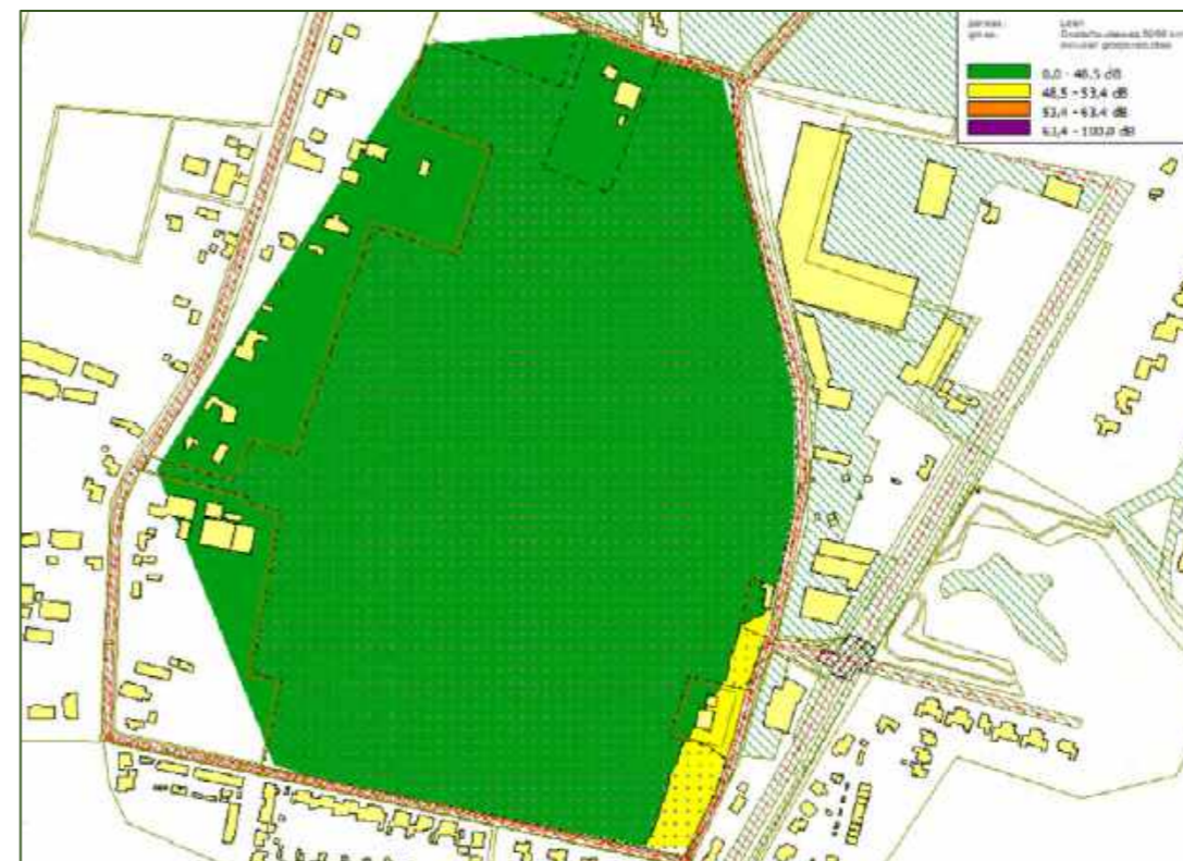
Figuur 4.3: geluidbelasting t.g.v. wegverkeer op de Oosterhoutseweg (50/60 km/uur) incl. aftrek artikel 110g Wgh (gridhoogte 7,5 meter)
