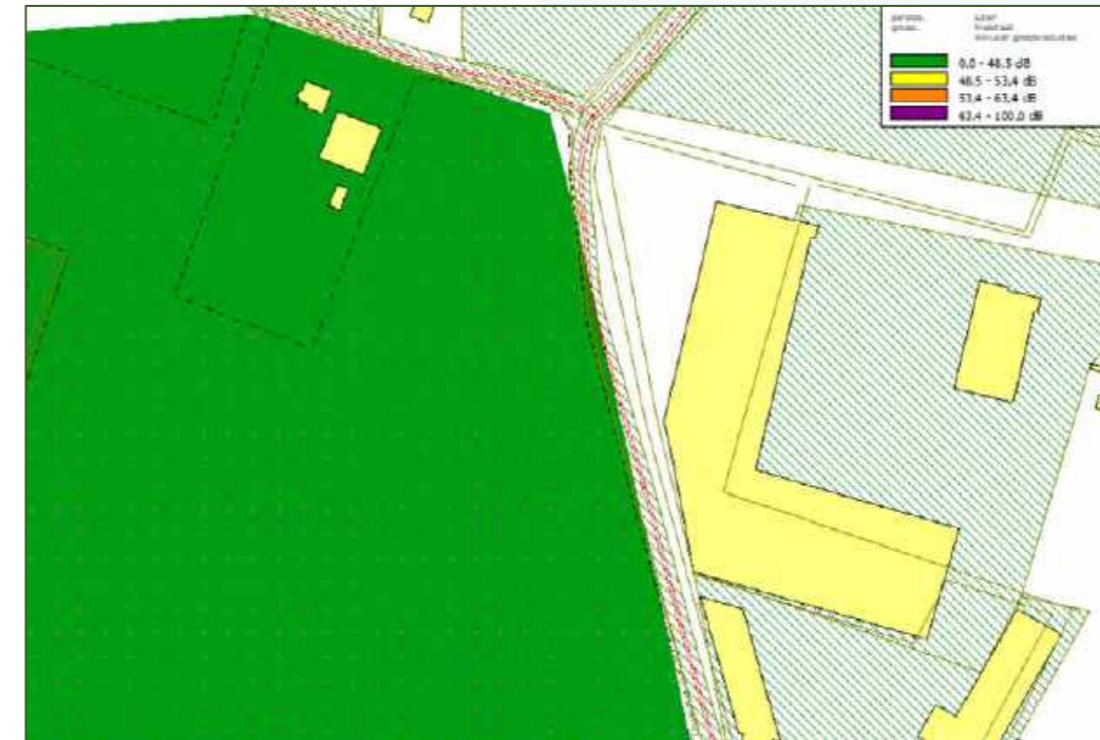
Figuur 4.10: geluidbelasting t.g.v. wegverkeer op de Heistraat incl. aftrek artikel 110g Wgh (gridhoogte 7,5 meter)
