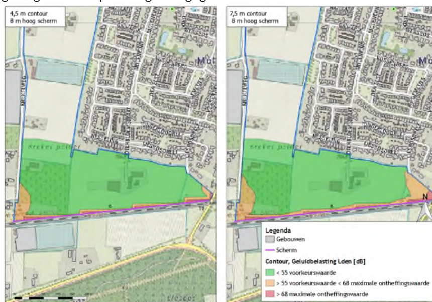
Figuur 5 geluidbelasting ten gevolge van de spoorweg inclusief een scherm met een hoogte van 8 meter met een afstand van 6 meter tot het spoor contourhoogte 4,5 en 7,5 meter
