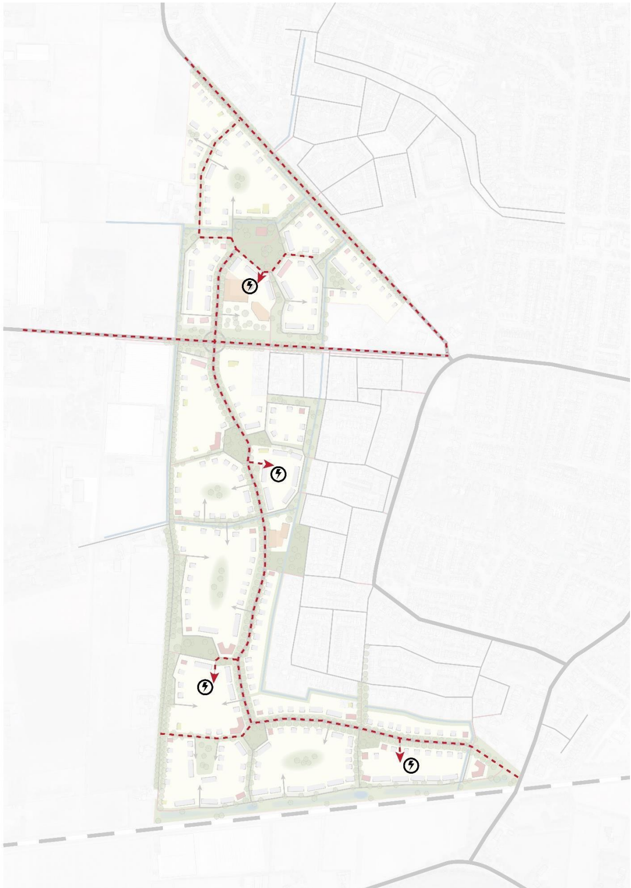
Hoofdtracé kabels en leidingen en locatie trafo's
